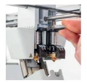
Bicos de troca rápida para materiais de construção e de suporte solúveis em água. Disponível em 0,4 e 0,8 mm
